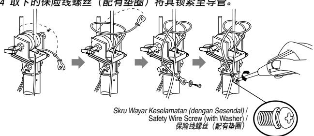
Skru Wayar Keselamatan (dengan Sesendal) / Safety Wire Screw (with Washer) / 保险线螺丝（配有垫圈）
