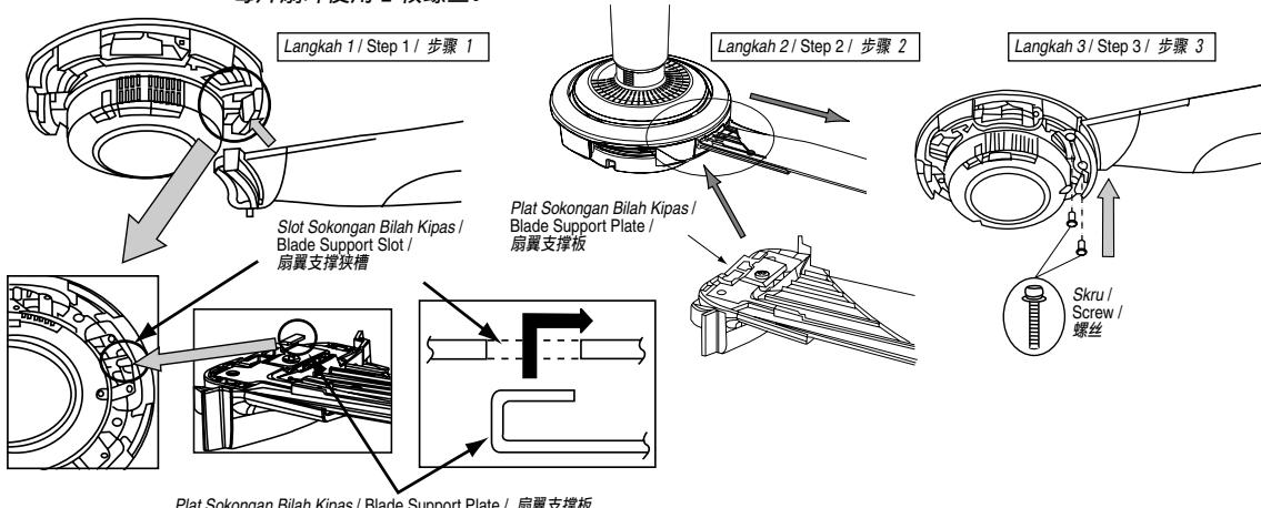
Plat Sokongan Bilah Kipas / Blade Support Plate / 扇翼支撑板
