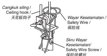
1. Kipas Siling dipasang dalam keadaan selamat pada cangkuk siling. / The Ceiling Fan is securely fixed onto the ceiling hook. / 吊扇被稳固地安装到天花板钩子。
