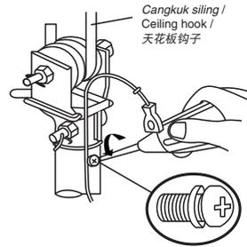
5. Lilit Wayar Keselamatan pada cangkuk siling dan skru ke Paip menggunakan Skru Wayar Keselamatan (dengan Sesendal) yang ditanggalkan pada Langkah A) 4 halaman 7. / Loop the Safety Wire to the ceiling hook and screw to the Pipe by using Safety Wire Screw (with Washer) which was removed in step A) 4 page 7. / 将保险线圈结至天花板钩子并使用在第 7 页步骤 A) 4 取下的保险线螺丝（配有垫圈）将其锁紧至导管。
