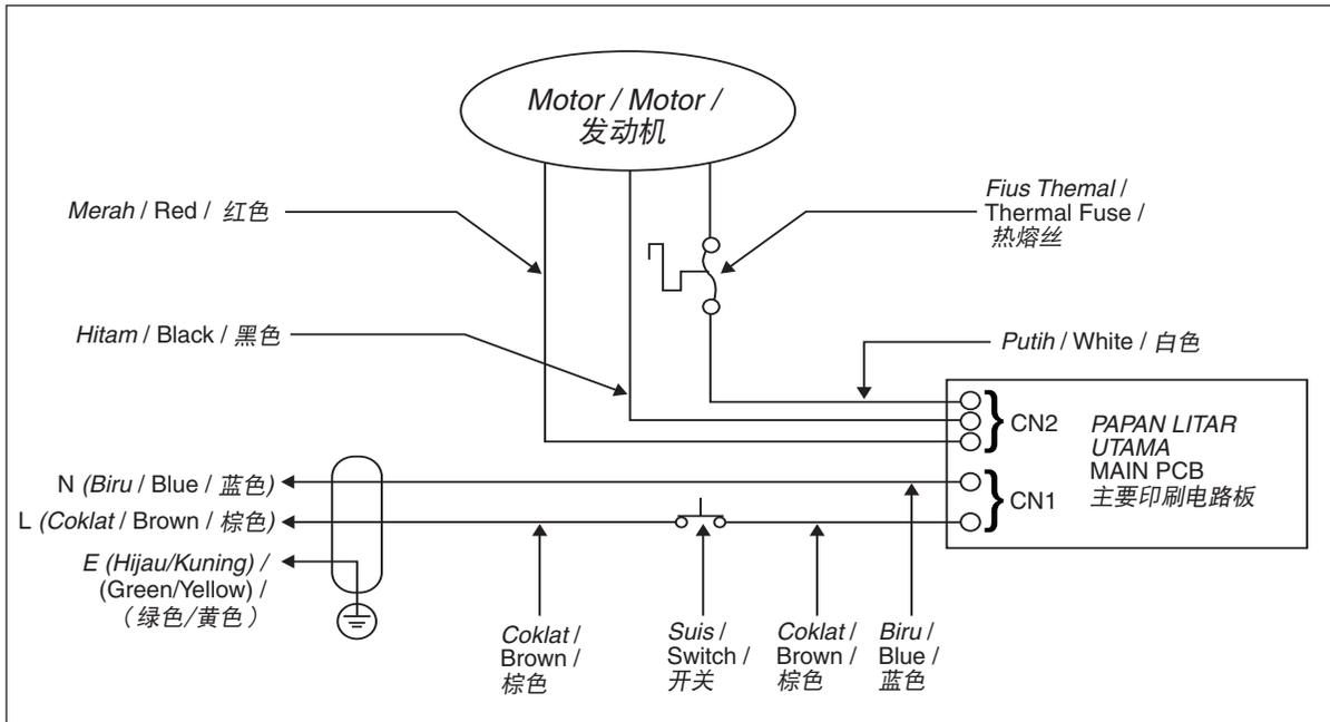
**PEMASANGAN PADA SUMBER KUASA / CONNECTING THE POWER SUPPLY / 连接电源**
