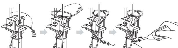
Skru Wayar Keselamatan (dengan Sesendal) / Safety Wire Screw (with Washer) / 保险线螺丝（配有垫圈）
