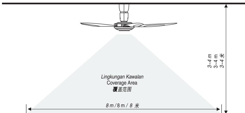
Rajah di atas menunjukkan lingkungan kawalan yang terbaik. Ketinggian siling untuk pemasangan yang terbaik ialah 3~4 m. Alat Kawalan Jauh ini mestilah ditujukan ke arah Kipas Siling ketika menggunakan.
